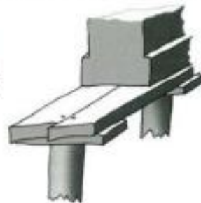
Fundering op stuit met enkele rij palen ('Rotterdamse' fundering)
