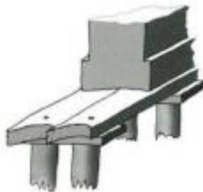
Fundering op stuit (paalfundering) met dubbele rij palen '(Amsterdamse' fundering)
